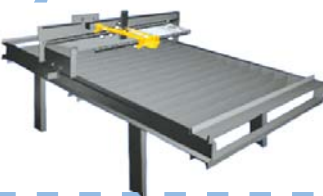
Ein Brennschneidstisch hilft bei der Metallverarbeitung
