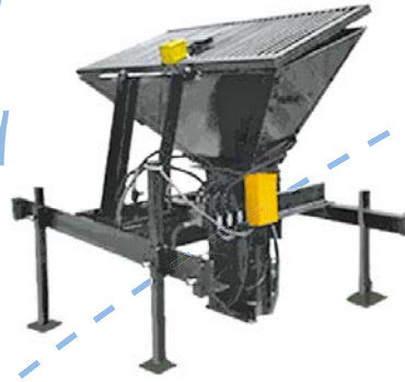
Die Ziegelpresse verarbeitet Lehm zu Mauersteinen. Sie schafft 16 pro Minute
