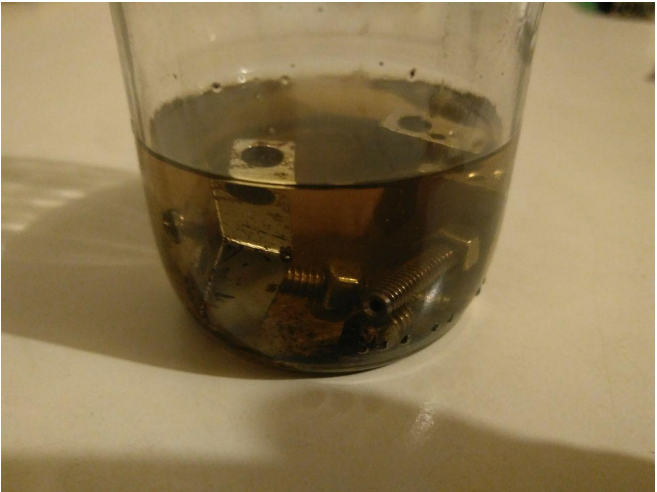
Abbildung 6: Verstopfte Hotend-Bauteile eingelegt in Aceton
