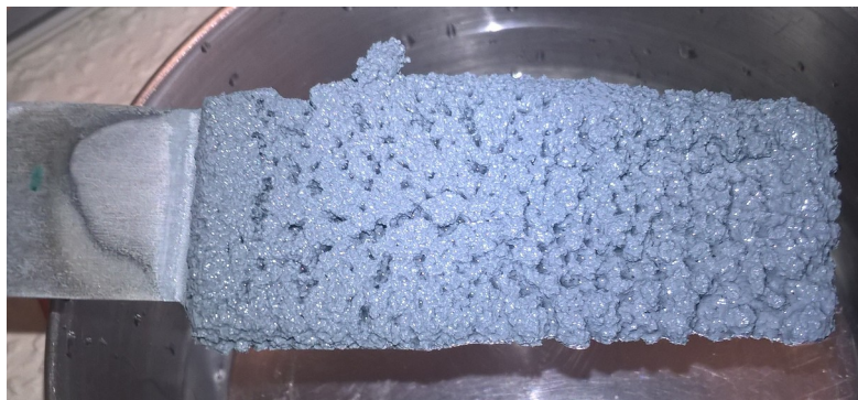
ca. 6g abgeschiedener Zinkschwamm auf Zn-Elektrode
