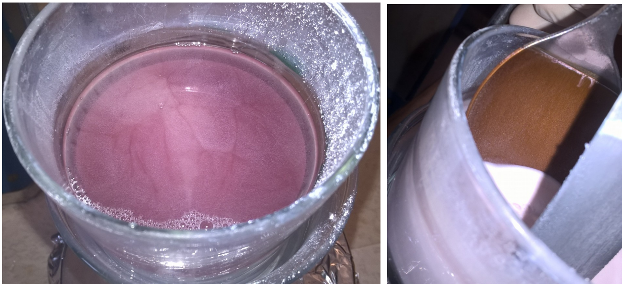
links: charakteristische Farbe des Elektrolyten nach Korrosion der Elektrode; rechts: korrodierte Anode
