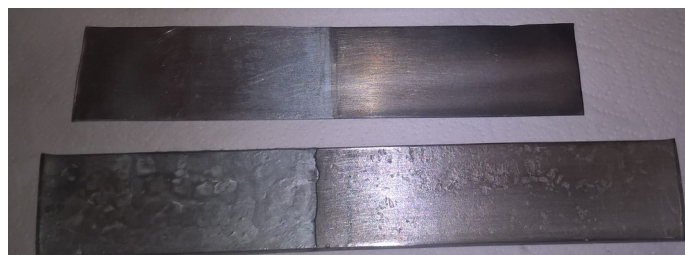
Eisenabscheidung auf Titanzinkkathode
