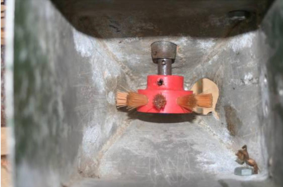
Dieses Bild zeigt ein fertig montiertes „Sembdner“- Rad in einer älteren Handsämaschine.
