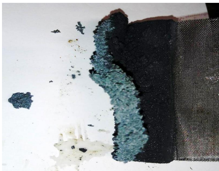
Abbildung 3: Ergebnis der Zinkbildung an der Kathode, Vorversuch 01
